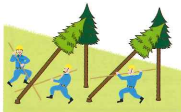
(図2)かかり木の処理
